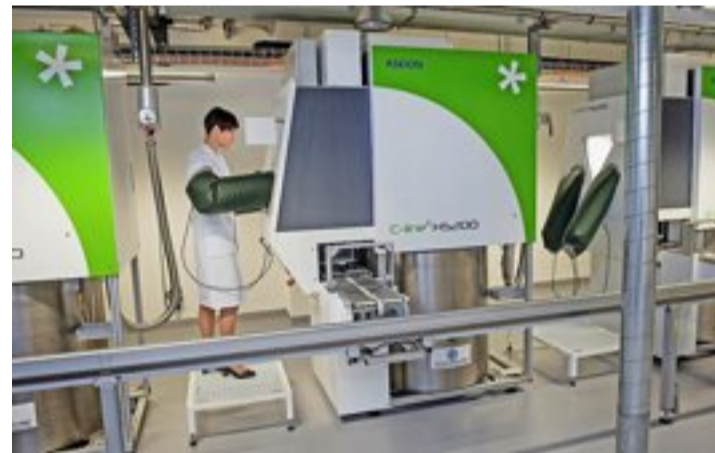
Will Tanja Fröhlich bei den Robotiktanks manuell eingreifen, tut sie dies über die angebrachten Ärmel, ohne dass der Kühlraum beeinflusst wird.
